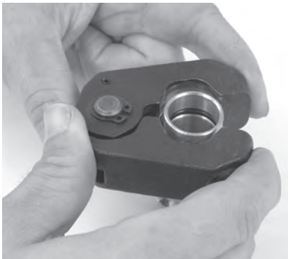
Abbildung 9 – Anbringen des Pressrings am Fitting
