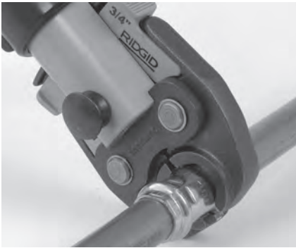
Abbildung 7 – Anbringen Pressbacke an Fitting
