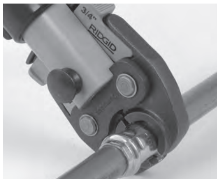
Рис. 7 – Установка пресс-клещей ножничного типа вокруг фитинга
