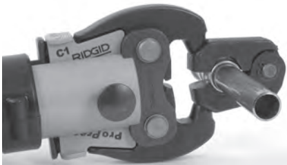
Abbildung 10 – Ansetzen der Ringbacke am Pressring
