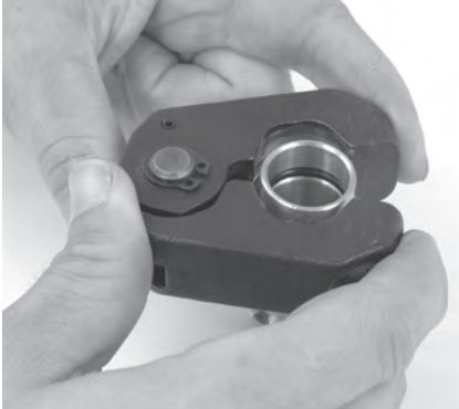
Рис. 9 – Установка обжимного кольца на фитинг
