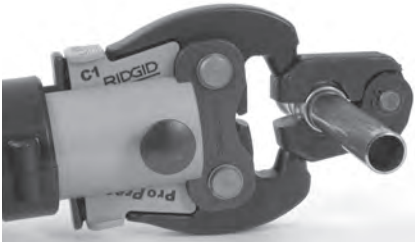
Рис. 10 – Крепление рабочей насадки на обжимном кольце
