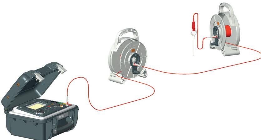
Inserire il puntale da un avvolgicavo nel centro dell'avvolgicavo successivo, per collegare a margherita gli avvolgicavi ed estendere in tal modo la lunghezza utile. Utilizzare il cavo in dotazione (con morsetto a pinza) per collegare la spina centrale dell'avvolgicavo a un picchetto di massa.
