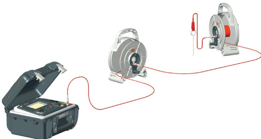
Trageți cablul de pe o rolă de cablu în centrul următoarei role, pentru a forma un lanț de role și a extinde lungimea utilizabilă. Utilizați cablul furnizat (cu o clemă crocodil) pentru conectarea de la mufa centrală a rolei de cablu la un țăruș din pământ.
