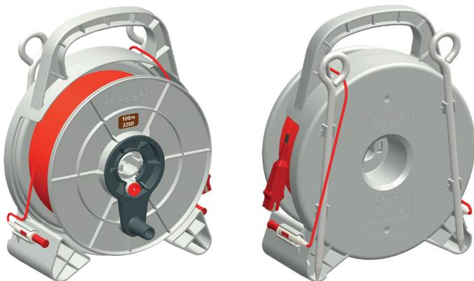
Stocker les pointes facilement à l'arrière de la bobine de câble.
