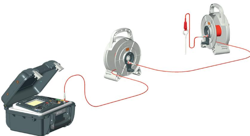
Az elérhető kábelhossz növeléséhez alkosson füzért a kábeltekercsekből, azaz csatlakoztassa az egyik kábeltekercs kábelét egy másik kábeltekercs közepéhez. A kábeltekercs középső csatlakozóját egy erre a célra biztosított (krokodilcspísszel ellátott) kábel segítségével csatlakoztassa egy, a földön elhelyezett mérőtűskéhez.
