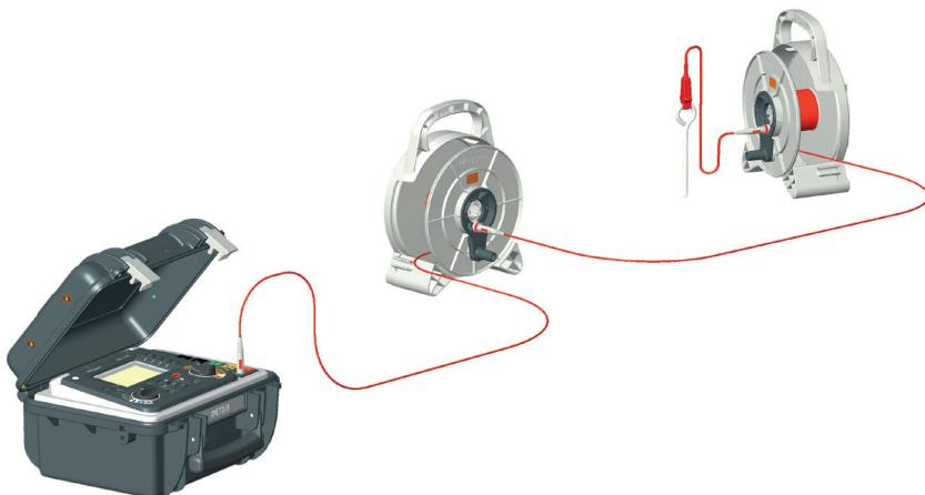
Zapojte kabel z jedné cívky doprostřed další cívky, takže vznikne řetěz cívek s kably, aby se prodloužil použitelný dosah. Použijte dodaný kabel (s krokosvorkou) k připojení ze středové zástrčky cívky k hrotu v zemi.
