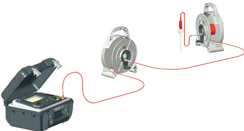
Conecte el cable desde un carrete al centro del siguiente carrete para formar una cadena de margarita y alargar el rango utilizable. Utilice el cable suministrado (con unas pinzas de cocodrilo) para conectarse desde el centro del carrete a una punta en el suelo.
