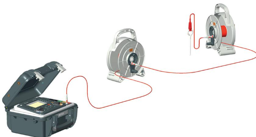
リードを1つのケーブルリールから別のケーブルリールのセンターに差し込み、ケーブルリールのデイジーチェーンを形成し、使用可能なレンジを拡張します。提供されているリール（ワニロクリップ付き）を使用して、ケーブルリールの中心のプラグから、接地したスパイクに接続します。
