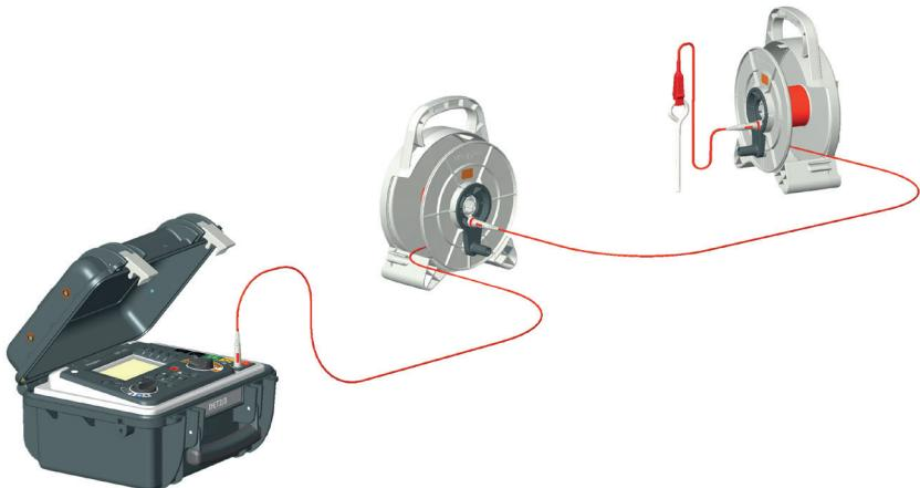
Die Leitung von einer Kabeltrommel in den mittleren Anschluss der nächsten Kabeltrommel einstecken, um die Kabeltrommeln zu verketten und den nutzbaren Längenbereich zu vergrößern.
