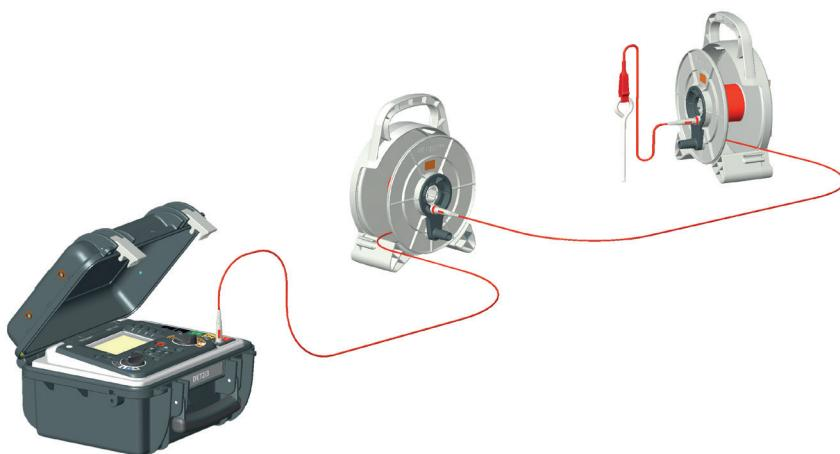
Branchez le cordon d'une bobine de câble au centre de l'autre bobine de câble, afin de former une guirlande de bobines et d'allonger la gamme utilisable. Utilisez le cordon fourni (avec une pince crocodile) pour le connecter depuis le centre de la bobine de câble prise jusqu'à une pointe dans le sol.
