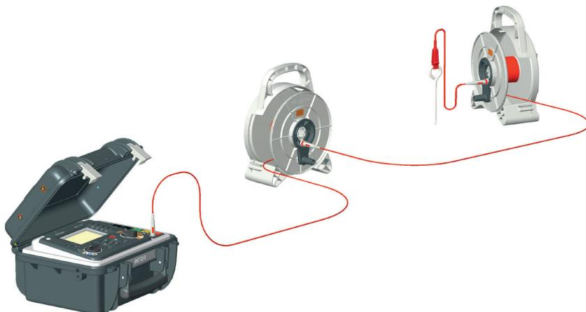
Sätt i kabeln från en kabelrulle i mittdelen av nästa kabelrulle för att skapa en kedjekoppling av kabelrullar som förlänger användningsräckvidden. Använd den medföljande kabeln (med en krokodilklämma) för att ansluta från mittkontakten på kabelrullen till en spets i marken.
