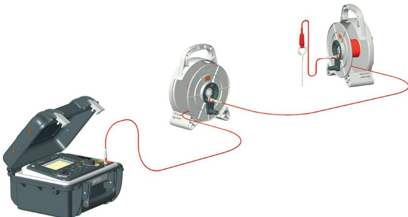
Należy podłączyć wtyk początku przewodu jednej szpuli do gniazda przy osi drugiej szpuli, tworząc w ten sposób połączenie łańcuchowe (szeregowe). Do połączenia gniazda pierwszej szpuli kablowej z uziomem należy użyć przewodu zakończonego zaciskiem krokodylkowym.
