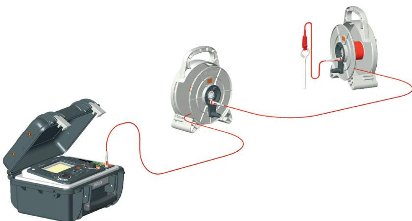
Zapojením vodiča z jedného kálového bubna do stredu ďalšieho kálového bubna môžete kálové bubny zret'azíť, a tým predlžiť použiteľný dosah. Na prepojenie medzi stredovou zástrčkou kálového bubna a sondou v zemi použite dodaný vodič (s krokosvorkou).
