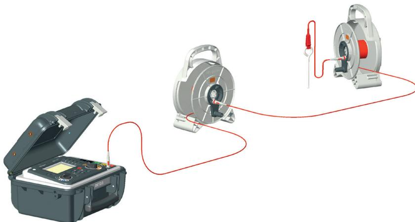
Conecte a ponta de uma bobina de cabo ao centro da próxima bobina de cabo, para formar uma corrente margarida de bobinas de cabo, para aumentar o intervalo utilizável. Use a ponta fornecida (com um clip jacaré) para conectar do plugue central da bobina de cabo até uma cavilha no chão.
